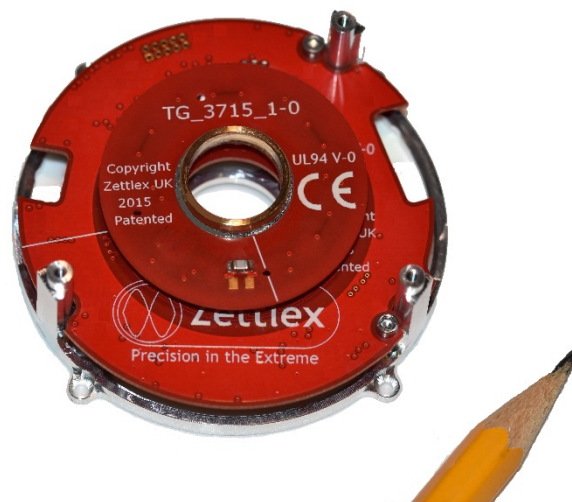
図 5 – 新世代の誘導 IncOder – どんな環境下でも高正確度です
