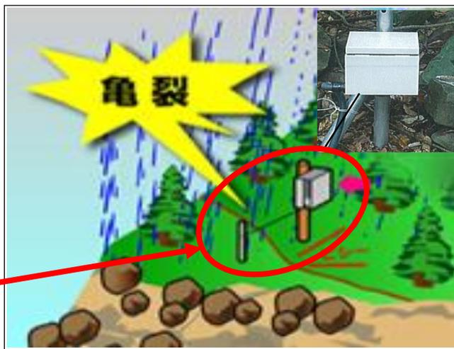
装置自体が山間部に設置されている事で、温度変化の激しい環境下でCE58Mを使用しています。使用温度範囲が-20~+80℃と広いので、問題なく使用しています。
