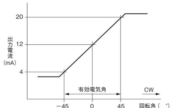
シャフト先端の合マークをコード引き出し方向に合わせると出力電流が12mAになります。
